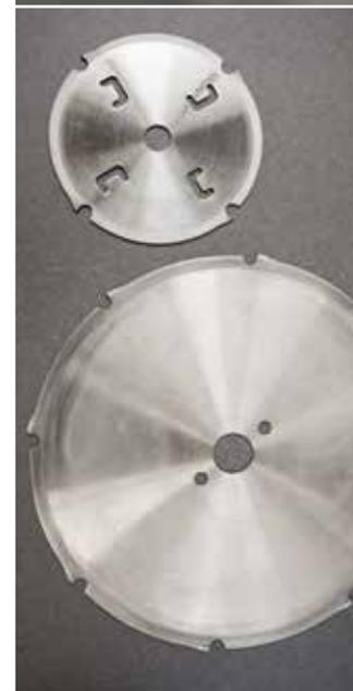
Los discos deben regularse para que sobresalgan un máximo de 10-15 mm. por debajo del panel para permitir la evacuación de los resto de corte.
