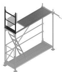
Colocação da meia-perna de andaime
