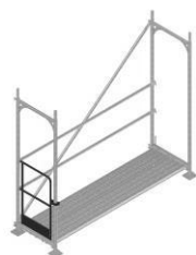
Colocação de resguardo lateral c/rodapé
