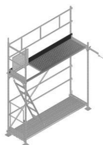
Colocação de rodapé frontal (ponto 12) "colocação do rodapé"
