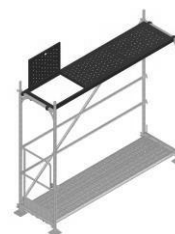
Colocação de prancha dupla c/alçapão R 75 galvanizada Ativação de perno de segurança (ponto 16.1)
