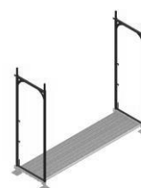
Colocação das pernas de andaime
