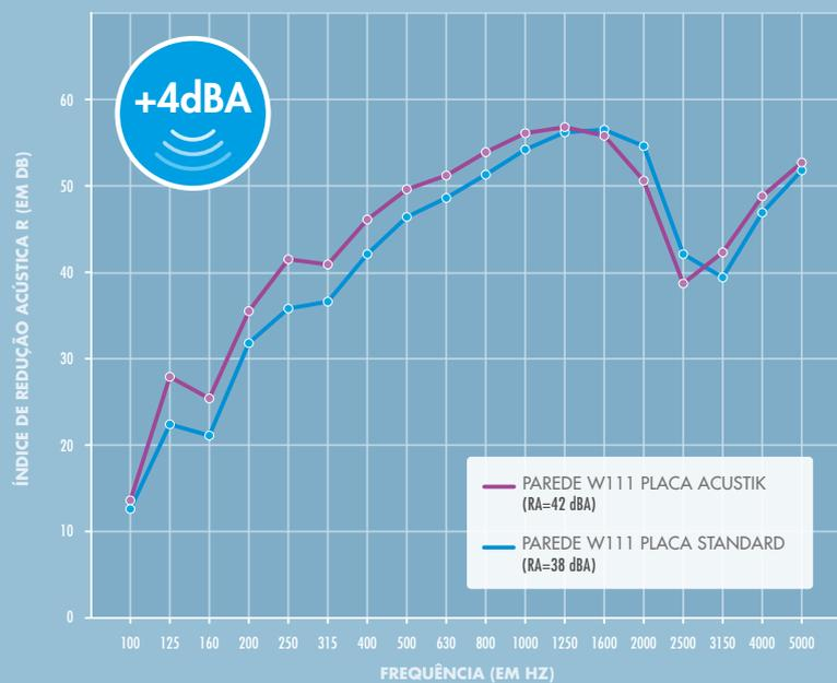
\* Ensaio realizado segundo a nova norma de ensaio UNE EN 16703 para sistemas de placas de gesso laminado
