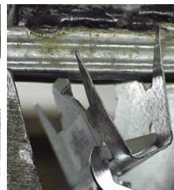
Modo de fallo del aislador. Se dobla una de las patillas de amarre al carril.
