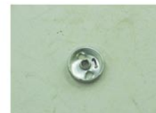
Modo de fallo. Se rasgan los hilos de la rosca
