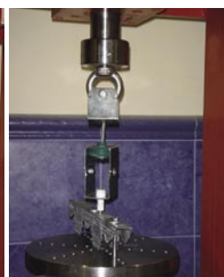
Muestra bajo carga 200 Kg.
