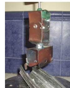
Detalle de la muestra bajo carga de rotura a 390 Kg.
