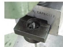
La cazoleta se introduce en el útil que la mantiene fija
