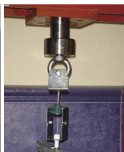
Muestra bajo carga 160 Kg.
