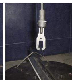
Muestra bajo carga de 85 Kg Se desprende la escudra.
