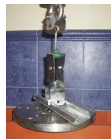
Detalle de la muestra bajo carga de 350 Kg.
