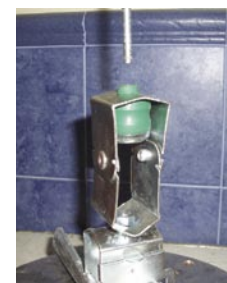
Detalle de la muestra bajo carga de rotura.
