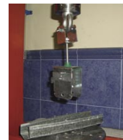
Muestra bajo carga de 450 kg Rotura por el perfil.
