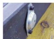
Suela M6 tras rotura
