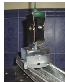
Detalle de la muestra bajo carga de 350 Kg.
